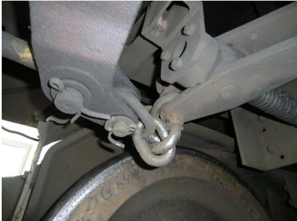
**Abbildung 31** Bremsmechanik Drehgestell 2 – Detail Bremszylinderkolben ausgefahren - Quelle TUE
