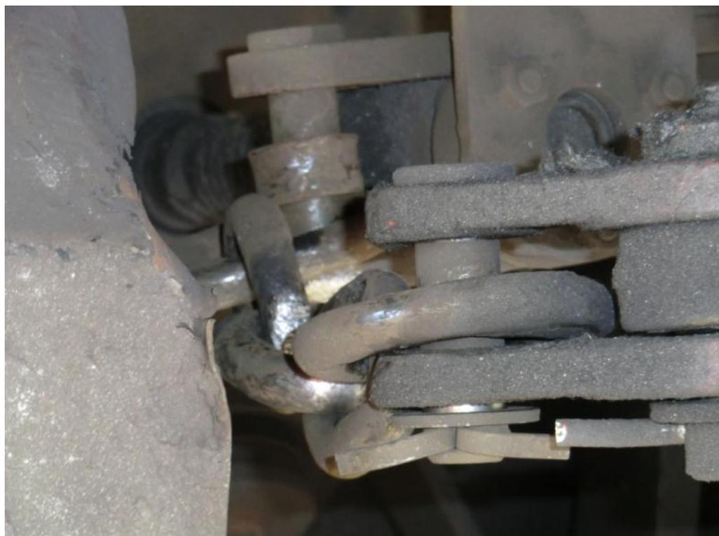
Abbildung 30 Bremsmechanik Drehgestell 2 – Detail - Quelle TUE
