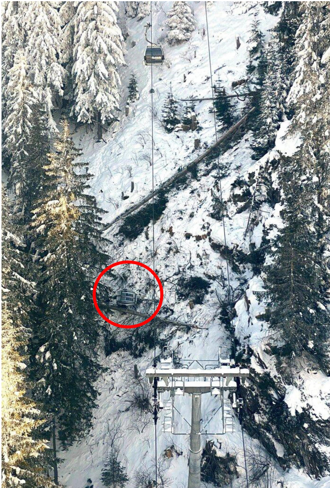
Abbildung 3 Abgestürzte Kabine Nr. 39
