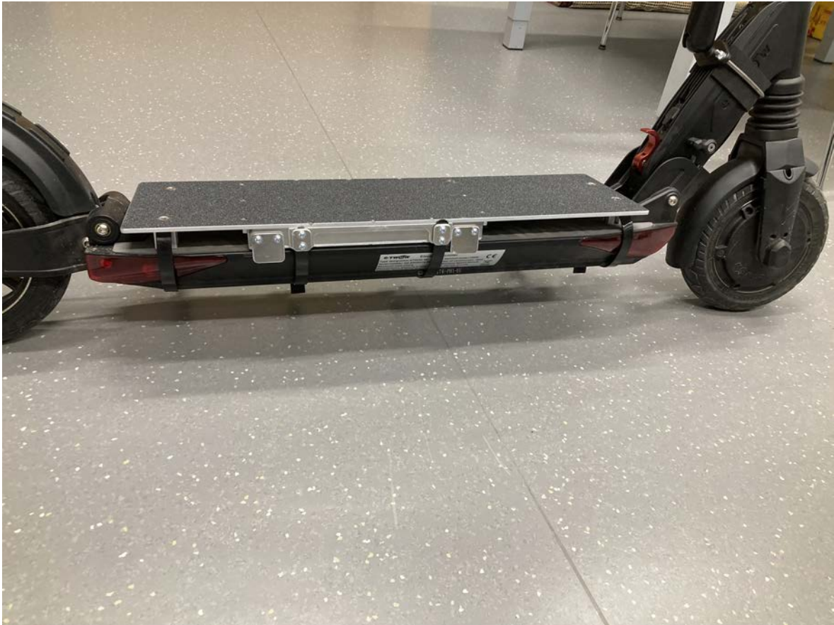
Abbildung 12: Aufbau an privat hochwertigem E-Scooter für die Messtechnik während Parcours-Versuchen (Quelle: SEED-Projektteam)
