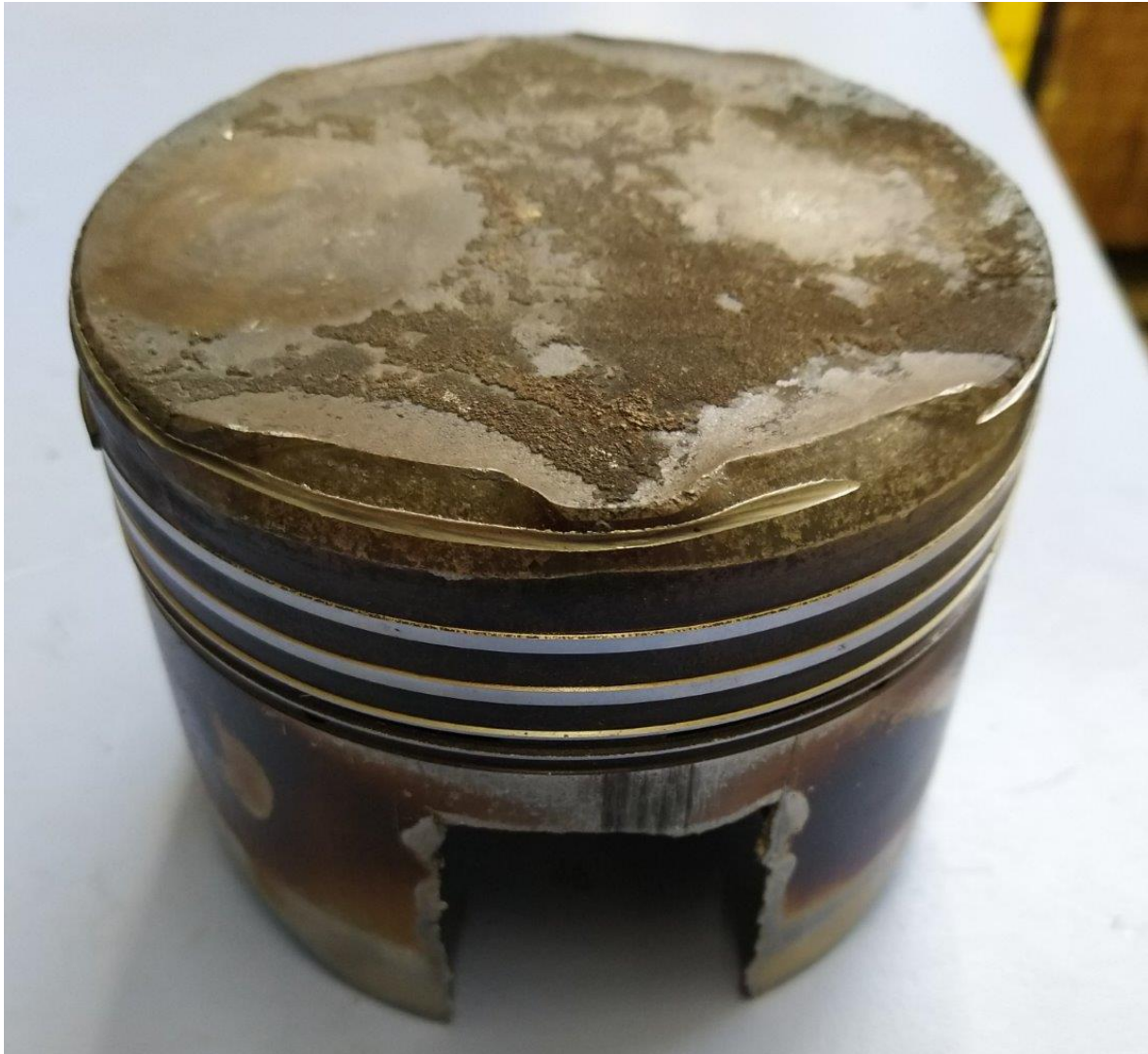
Abbildung 10 Außenseite von Kolben 4 (mit Kolbenringen) mit münzförmiger Materialabtragung am Kolbenboden (links) und sichelförmigen Verformungen am Umfang
