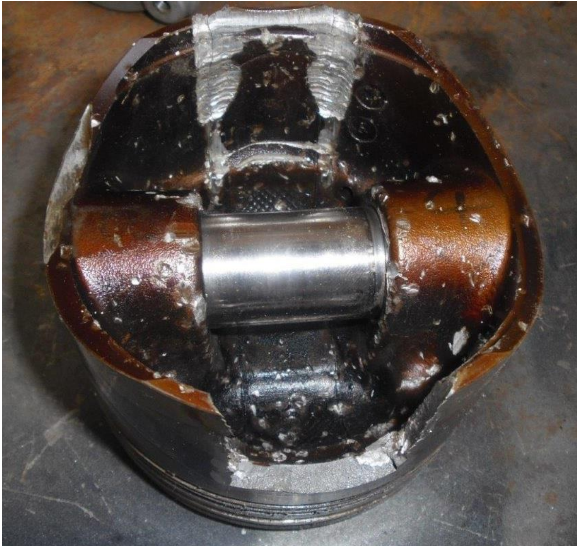
Abbildung 11 Innenseite von Kolben 4 (mit Kolbenbolzen) mit Brüchen, Riefen und Rissen im Kolbenschaft
