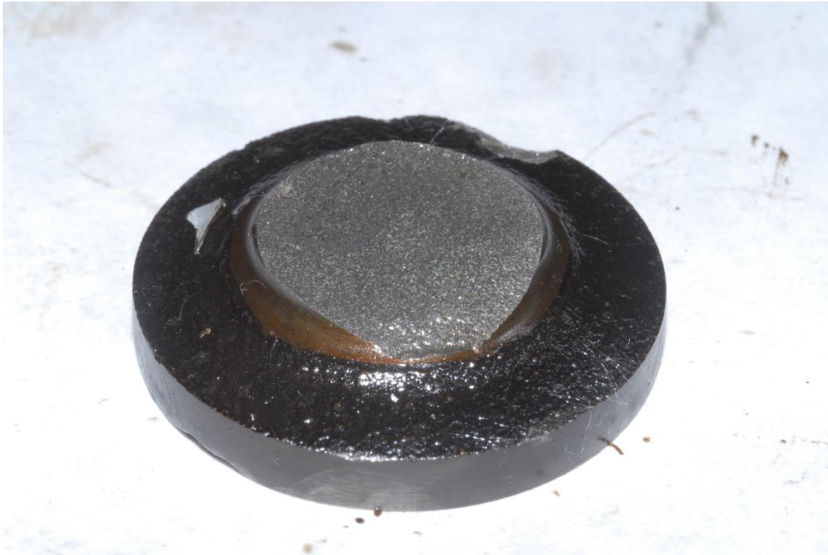
Abbildung 9 Fremdkörpereinschläge auf der Rückseite des Stößeltellers des gebrochenen Stößel des Einlassventils von Zylinder 4
