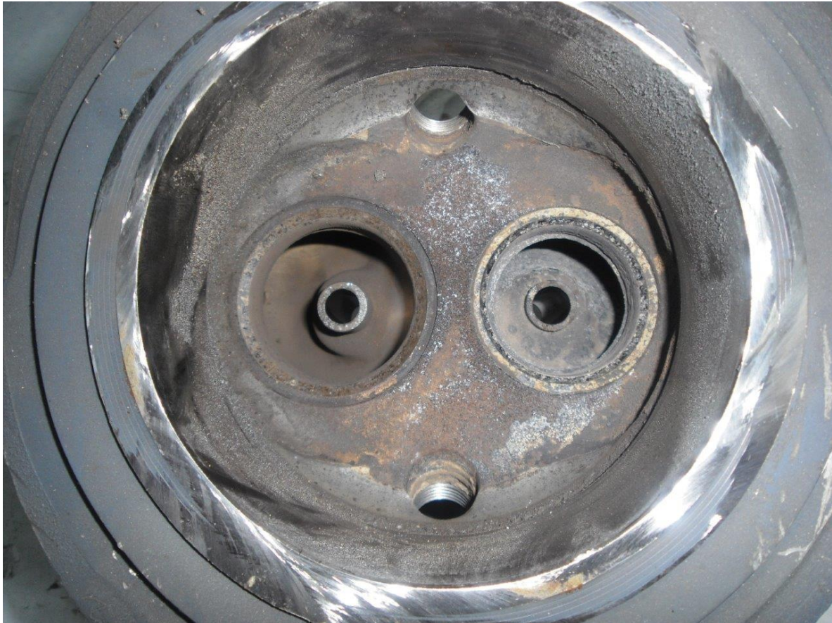
Abbildung 12 Sphärischer Brennraum von Zylinder 4 (ohne Ventile und Zündkerzen) mit sichelförmigen Fremdkörpereinschlägen links und rechts der Zündkerzenbohrungen
