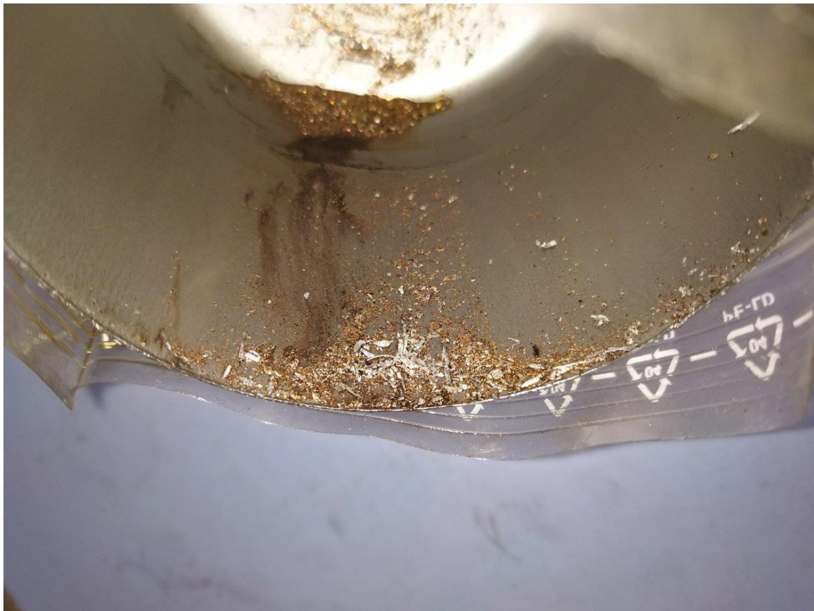
Abbildung 6 Metallpartikel im Gehäuse des Einweg-Ölfilters (aufgeschnitten)
