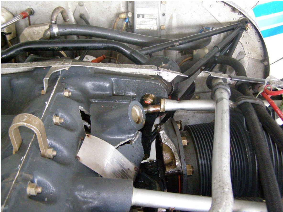
Abbildung 2 Zustand von Kurbelgehäuse und Zylinder 4 nach der Bergung des Flugzeugs
