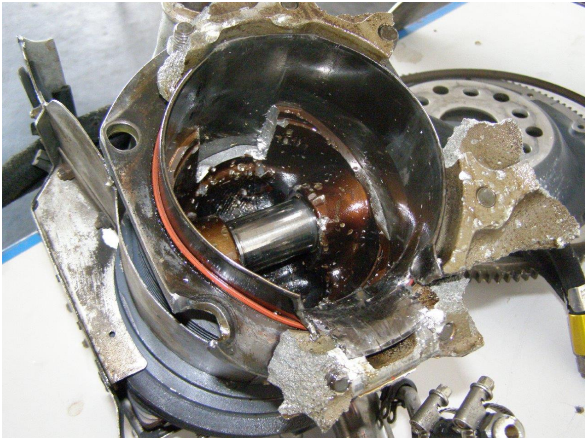
Abbildung 4 Zustand von Zylinder 4 und Kolben 4
