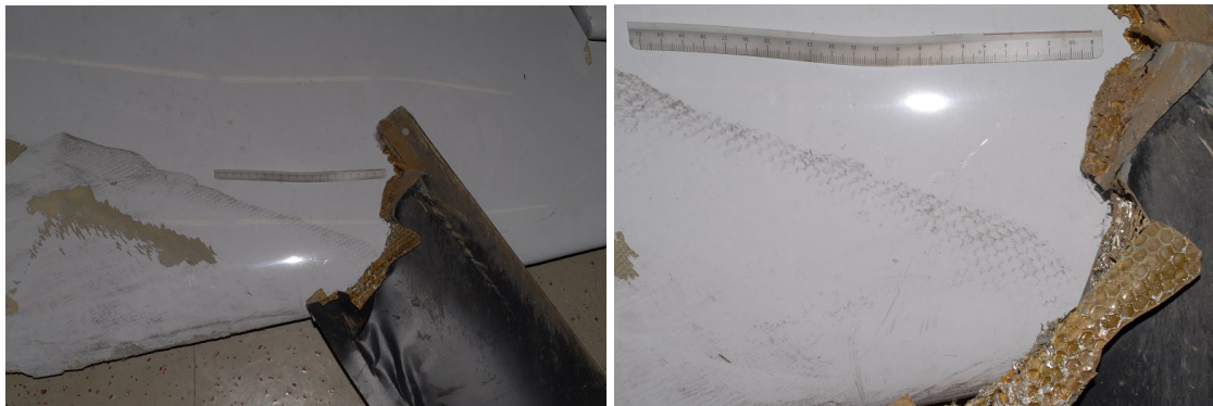
Abb. Höhenleitwerk – Abriebspur auf Flossenoberseite und Gegenüberstellung mit Hauptrotorblatt von Hubschrauber B (Quelle: SUB)
