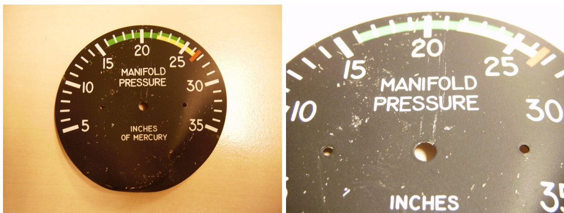
Abb. Ladedruckanzeige mit Zeigerabdruck – Übersicht und Detail (Quelle: SUB).
