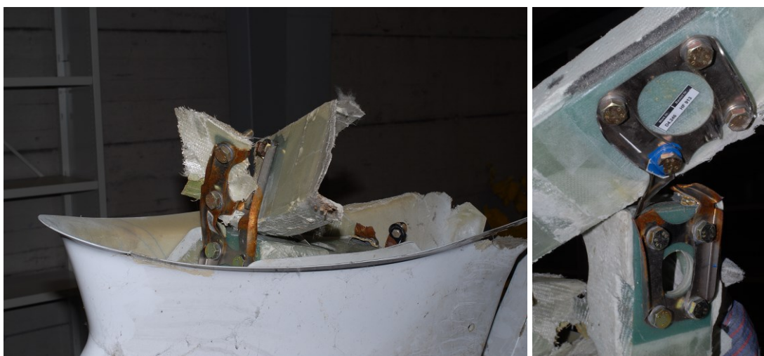
Abb. Höhenleitwerk – Vorderer und hinterer Anschlussbeschlag der Höhenflosse (Quelle: SUB).
