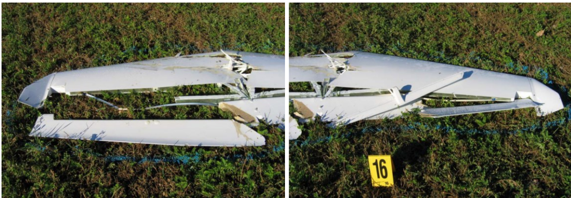
Abb. Teilefeld A-B (SPZ 16) – Höhenflosse mit Randbögen, Höhenruder und Trimmklappe von Flugzeug A (Quelle: SUB)
