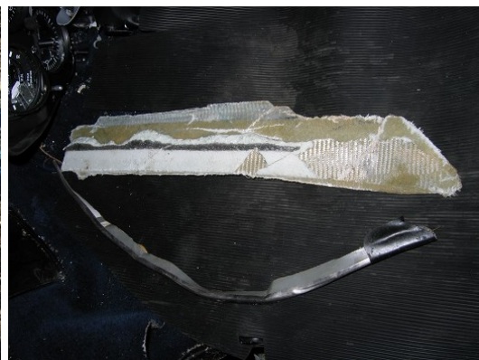
Abb. Kabine – Rechte vordere Kabinentür (SPZ 7), Nasenleiste eines Propellerblatts und ein GFK-Bruchstück von Flugzeug A (Quelle: SUB).
