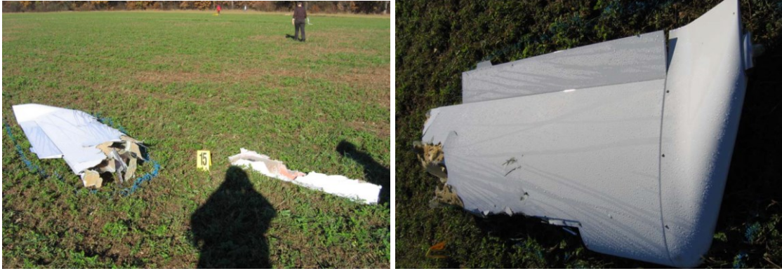
Abb. Teilefeld A-B (SPZ 15) – Linke Tragfläche und Bruchstück der Flügelnase von Flugzeug A (Quelle: SUB)
