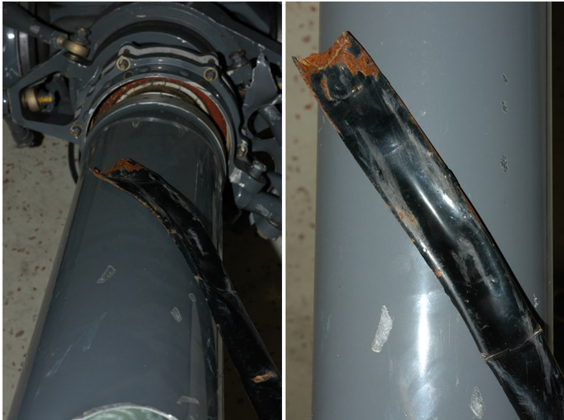
Abb. Lange Querruder-Stoßstange der linken Tragfläche – Zustand und Gegenüberstellung mit Hauptrotormast von Hubschrauber B (Quelle: SUB)
