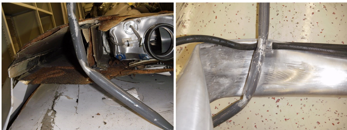
Abb. Hauptrotor-Steuerstangen – Zustand und Gegenüberstellung mit Tankeinfüllstutzen und Flügelholm der linken Tragfläche von Flugzeug A (Quelle: SUB).
