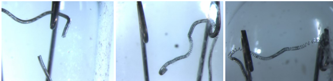
Abb. Beispiele für Glühfadenbrüche und -verformungen – Glühfaden kalt gebrochen; Glühfäden mit Warmverformung mit und ohne Fadenbruch (Quelle: UUB).
