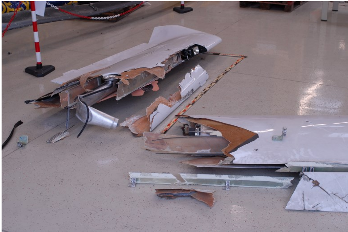
Abb. Linke Tragfläche – Rekonstruktion mit Tankeinfüllstützen (Quelle: SUB).
