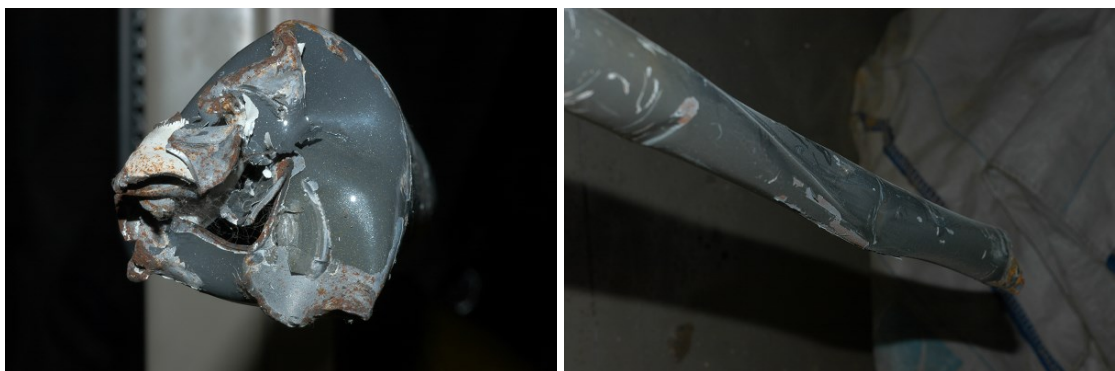
Abb. Mittleres Bruchstück der langen Heckrotorantriebswelle – Vorderes und hinteres Bruchende (Quelle: SUB).
