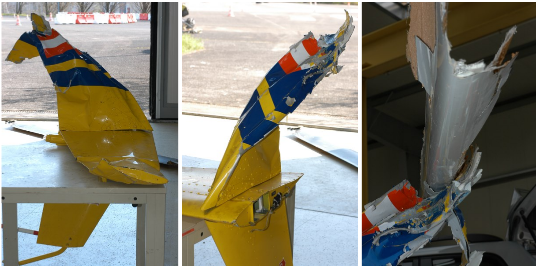
Abb. Obere vertikale Stabilisierungsflosse – Zustand und Gegenüberstellung mit Bruchstück der Flügelnase der linken Tragfläche von Flugzeug A.
