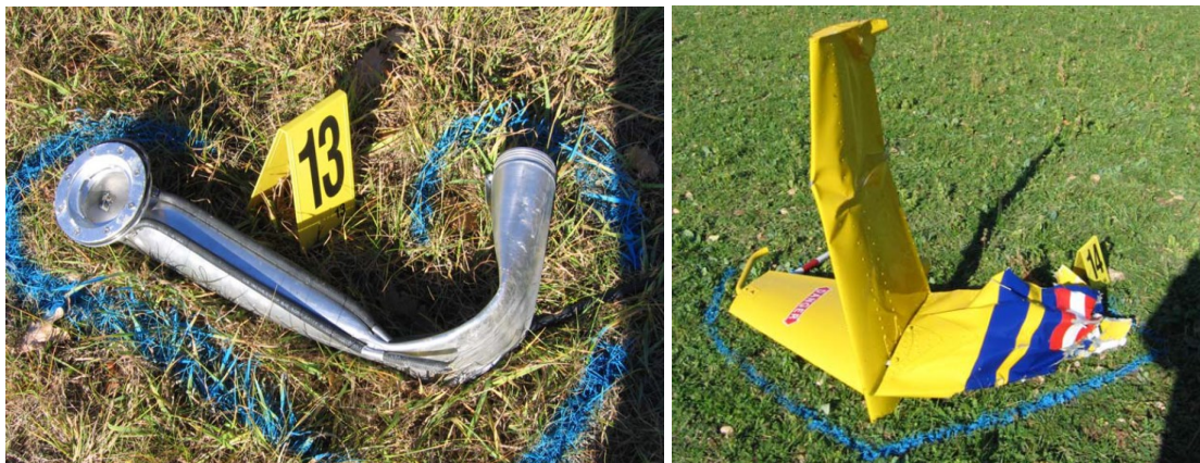
Abb. Teilefeld A-B (SPZ 13 & 14) – Einfüllstutzen des Haupttanks von Flugzeug A, Leitwerk von Hubschrauber B (Quelle: SUB)
