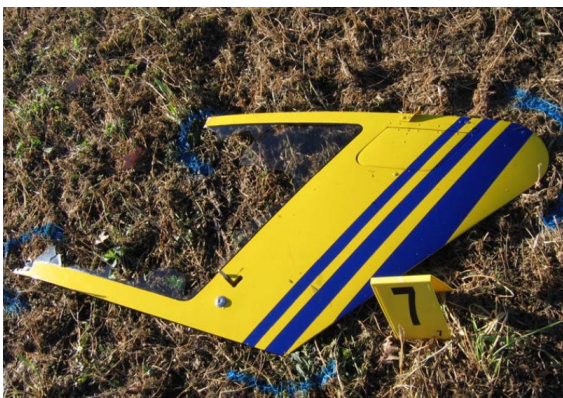
Abb. Kabine – Rechte vordere Kabinentür (SPZ 7), Nasenleiste eines Propellerblatts und ein GFK-Bruchstück von Flugzeug A (Quelle: SUB).
