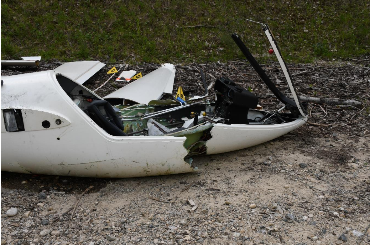
Abbildung 11 Riss in der CFK-Schale (Cockpit)
