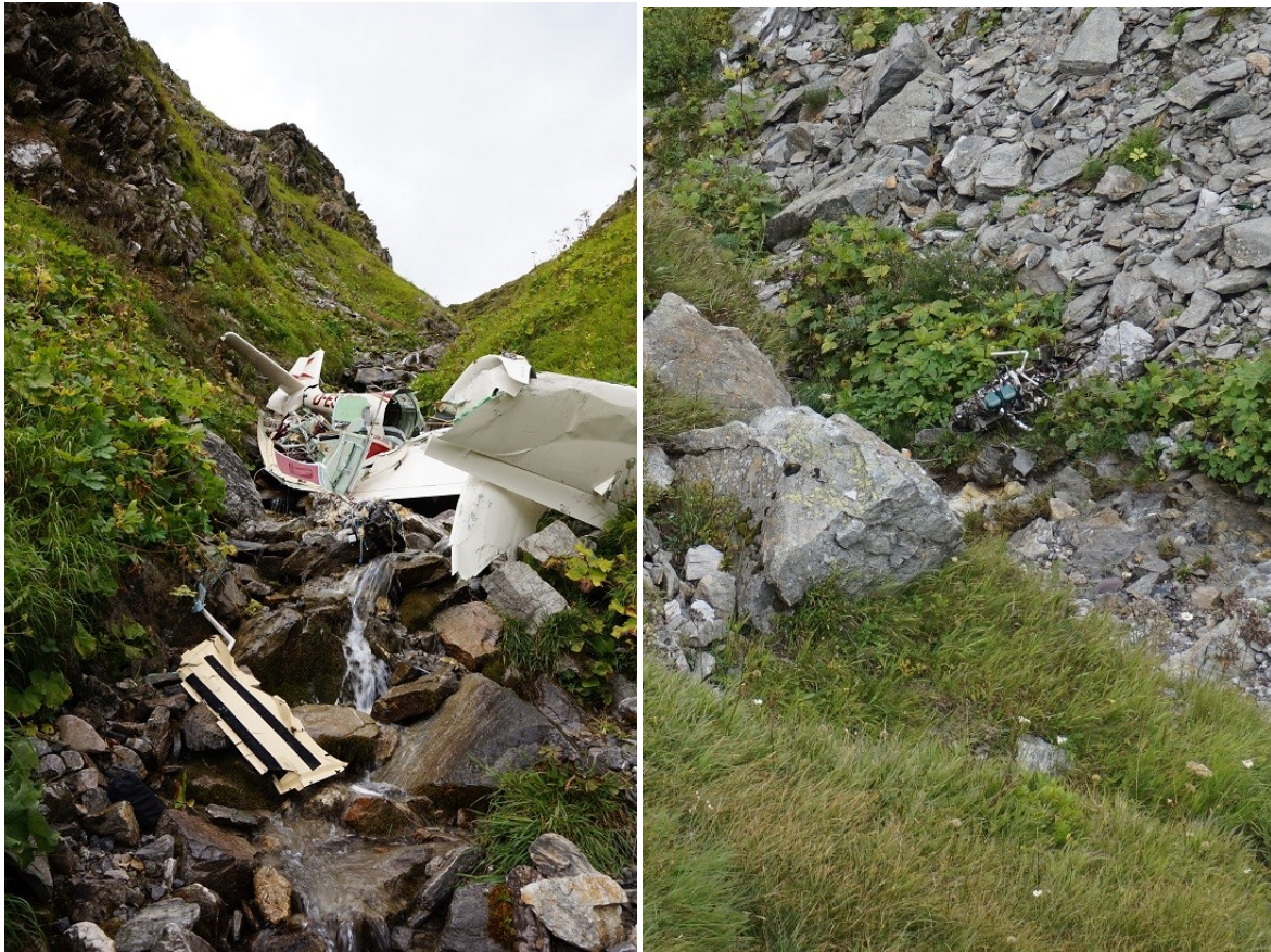
Abbildung 11: Bachbett des Steißbachs mit Hauptwrack (linkes Bild) und Triebwerk (rechtes Bild)
