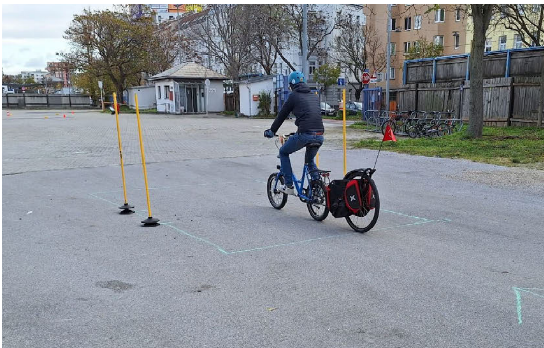
Abbildung 20: Fahrzeug i:sy mit angehängtem Extrawheel bei der Station 2 Bremsen (© verkehrplus)
