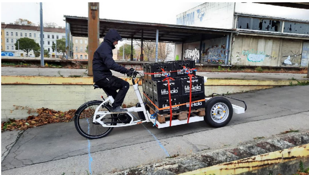
Abbildung 21: Fahrzeug Urban Arrow Tender mit Zuladung beim bergan Anfahren auf Station 3 Neigungen (© verkehrplus)
